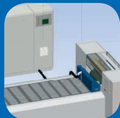
Pulizia del cliché durante la tiratura
